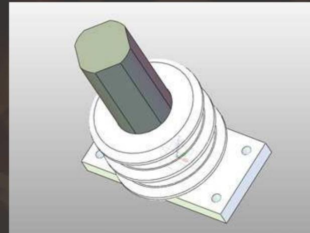
Colonnina in neonite per motore trazione 4EXH4046
