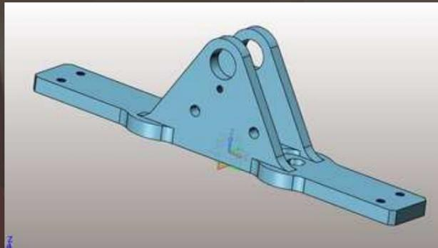
Supporto assieme spazzole in acciaio per collettore a spazzole sollevabili per motore ABB
