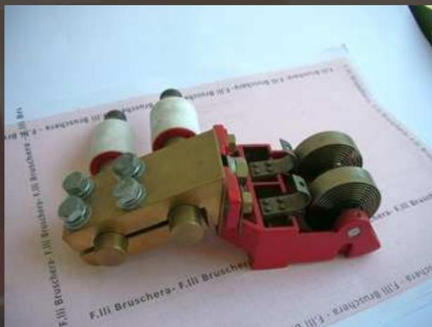
Portaspazzole con morsetto e colonnine m.t. DM05736 (ČSD E 499.3 / FNM E.630)
