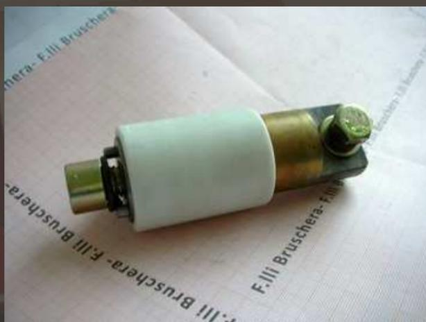
Colonnina in Micaver completa per motore trazione MP4B-RT1365/S
