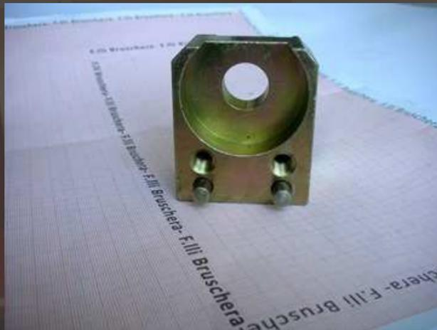
Blocchetto di posizionamento per motore trazione T910
