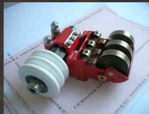
portaspazzole, morsetto e colonnina per motore trazione 82-400 / 82-333 (E.656)
